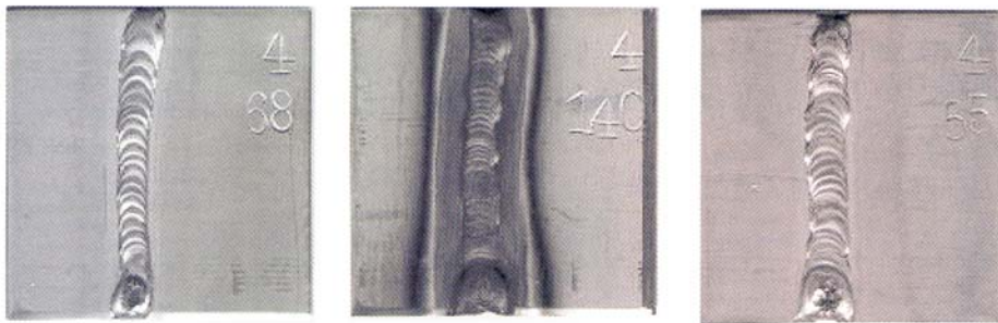
Abb. 3: Entfernung von Anlauffarben beim Edelstahlschweißen. Testbleche: A) „biologisch“ gebeizt, B) ungebeizt, C) mit Flusssäure (Antox) gebeizt.
